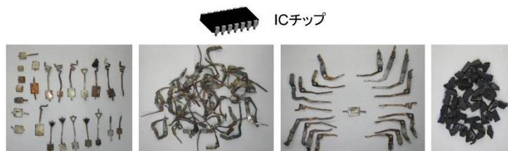
電気パルス粉碎によってICチップの単体分離された各種素材
