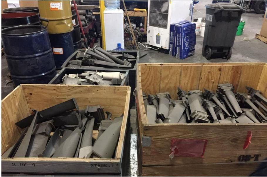
図9. ニッケル基超合金タービンブレードのスクラップ。世界各地の航空機や発電所で発生した使用済みスクラップが集荷される。ニッケル基超合金スクラップの中にはレニウムやタンタルを含むものも多い。
