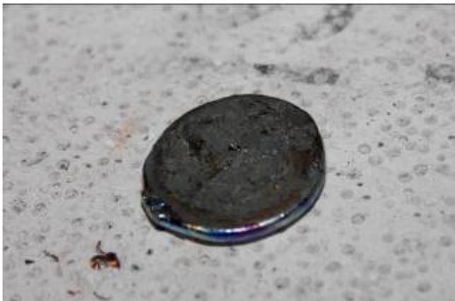
合金を灰の上で加熱・溶融すると、鉛は酸化鉛となり灰に吸収され、金のみが灰の上に残る。今回は灰ではなくCUPEL—BONEASHという物を使った。加熱・溶融にはガスバーナーを用いたが酸素が足りず、うまくいかなかったため電気炉
