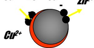
Cuの標準単極電位は、+0.337Vであり、Zn末上に容易に析出。これによりCu-Znガルバニ電池が生成。
