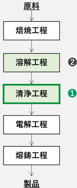
Fig. 亜鉛製錬工程概略図
